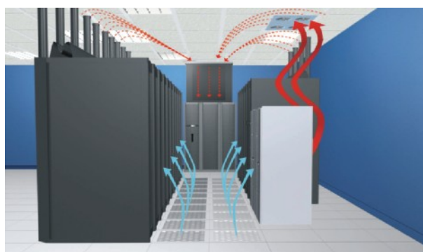
Εικόνα 1. Παραδοσιακός τρόπος εγκατάστασης Datacenter (με ψευδοπάτωμα)
